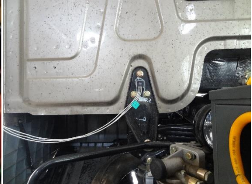
左侧驾驶室悬置加速度测点布置
